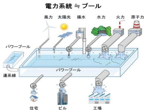
上流側からは火力、水力、原子力、太陽光等の発電所からの電力が供給され、下流の工場、ビル、住宅などの需要側に供給されるイメージが示されている。このような供給と需要の間を取り持つのがパワープールだ。我が国には大小様々なパワープーが存在する。小規模のものは各所に存在する離島、佐渡島等があり、中規模では北海道、東北、北陸、中国、四国、九州、沖縄の各電力管轄のものがあり、大規模では東京、中部、関西の各電力管轄のものがある。この絵ではプールを水槽で表現しているが実際にはこのような電気を貯めるバッテリーが存在するわけではないことに留意する必要がある。この水槽に相当するものは実際には各電源から送られてくる電気を連結し下流の需要側に送る送電線網を意味している。
