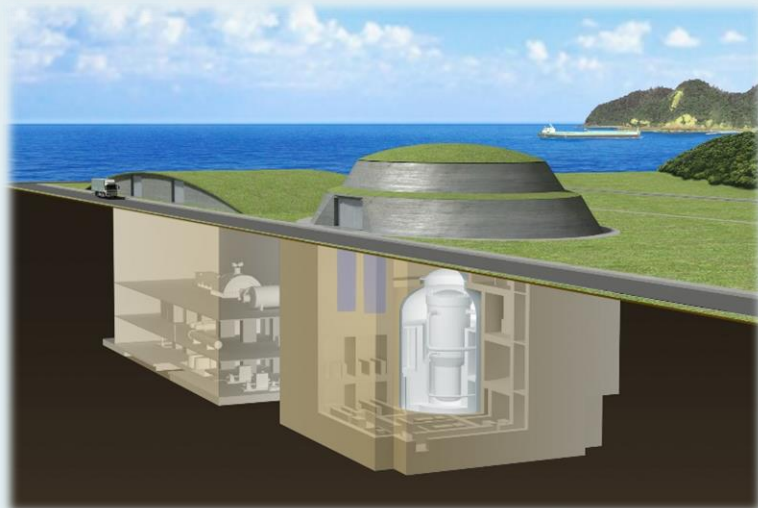
発電用小型軽水炉 (~30万kW)
