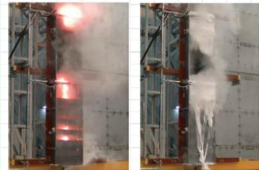
ケーブル火災時の自動消火設備消火性能試験
