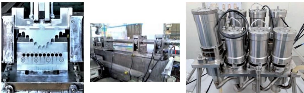
燃料ピンせん断機 レーザー集合体解体機 8段型遠心抽出機
