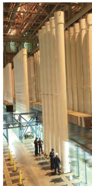
写真 1.4: ポーツマスのリードカスケードの大型遠心機 2012年11月ユーゼック公表
