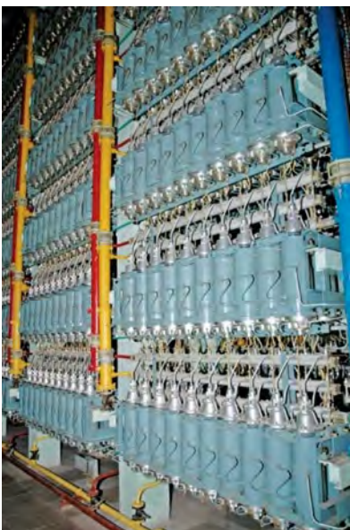
写真 1.2：ソ連の小型遠心機。ステイーンベック、ジッペの技術が引き継がれている。(2014AECC 資料)
