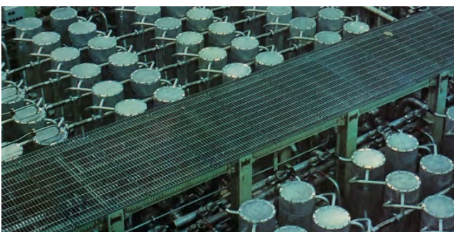
写真 4.2 C-2 カスケード。日本で最初に連続ウラン濃縮試験を実施した。日本原子力研究開発機構提供
