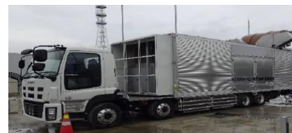
ガスタービン発電機車
