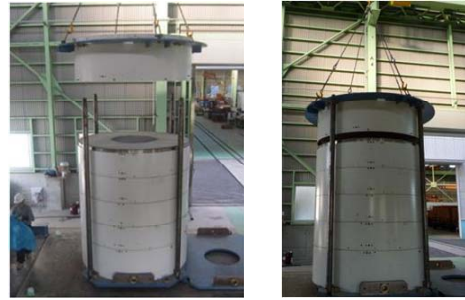
鋼殻リング法によるPEM組立実証 (RWMC、2011)
