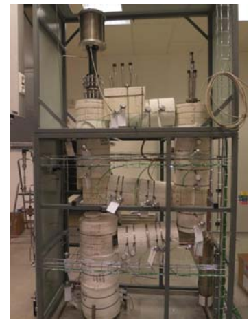
図 10. FREGAT フロー図 (NRI 資料を元に吉岡が作成) と、フリーベ・ループ
